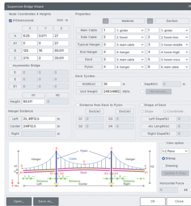
Suspension Bridge Wizard를 이용한 자정식 현수교 모델
